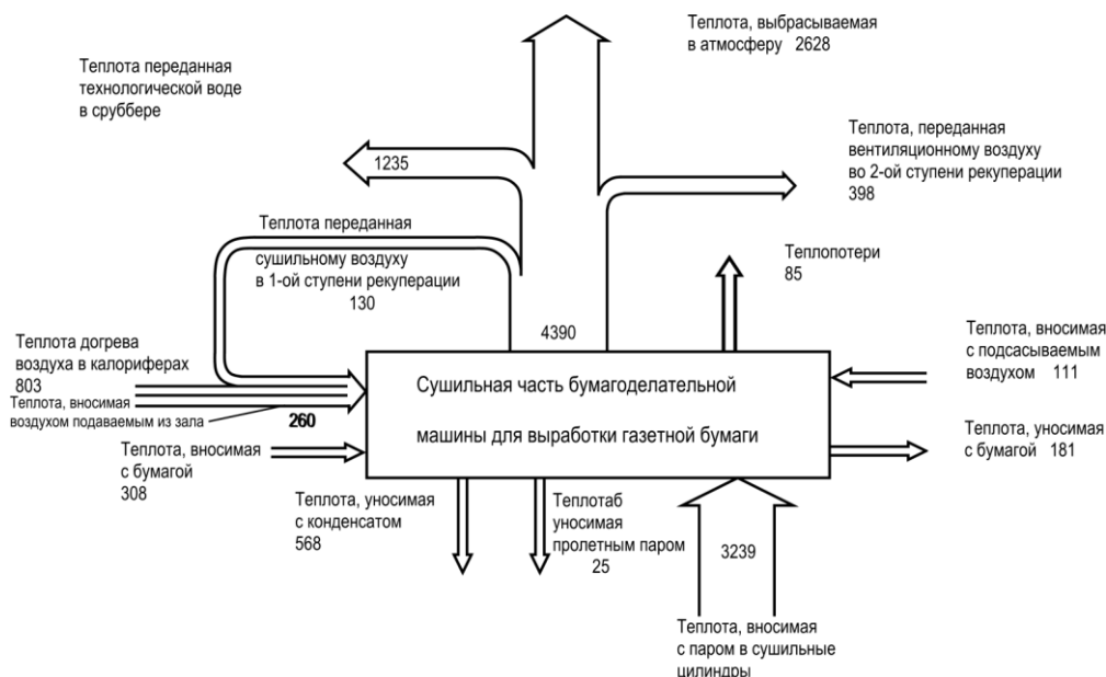
Рисунок 6 - Тепловой баланс сушильной части БДМ
